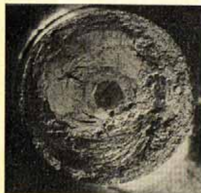
Рис. 195. Изломы сварных стыков инструмента, выполненных контактной сваркой (а), и стыков штоков, выполненных сваркой трением (б), в которых при ультразвуковом контроле были обнаружены дефекты.
