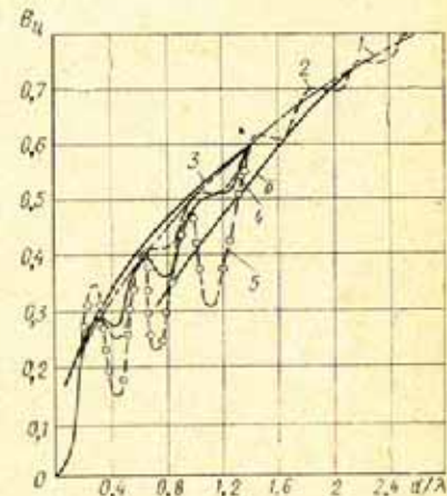
Рис. 64. Коэффициент, характеризующий отражательную способность цилиндра
