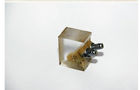
Рис. 2. ПЭП для реализации  $K_{ij}$ -способа: а — схема расположения пьезоэлементов и первый макет; б — эволюция конструкции: в результате серии экспериментов по её оптимизации создан окончательный вариант специализированного ПЭП с расположением пластин на двух соседних площадках призмы, ориентированных под углами  $\beta_1 = 40^\circ$ ,  $\beta_2 = 20^\circ$  и повернутых навстречу друг другу на угол  $4^\circ$  (на фото — внизу)
