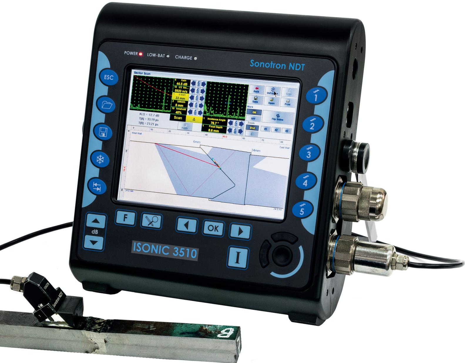
Обнаружение усталостной трещины (прием дифрагированного сигнала)
