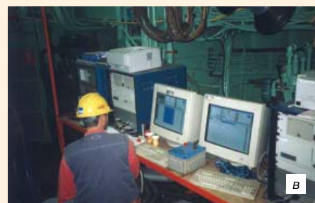
Рис. 1. Общий вид трубоукладочного корабля (а), установка/съем сканера и ПЭП на трубу (б), комната для размещения аппаратуры, управления сканированием и регистрации результатов контроля (в)
