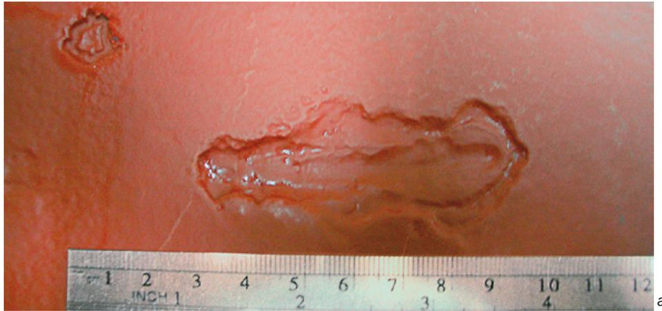
Рис. 4. Фотография донной поверхности контролируемого объекта (а) и его трехмерные отображения: б – восстановленное по накопленной первичной информации с дискретностью 7 мм, равной шагу сканирования, использованному при контроле; в – восстановленное по накопленной первичной информации с дискретностью 2 мм (виртуальное снижение шага сканирования вычислительными методами)
